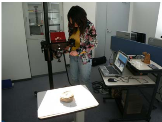
図1 3次元物体形状データ入力装置
