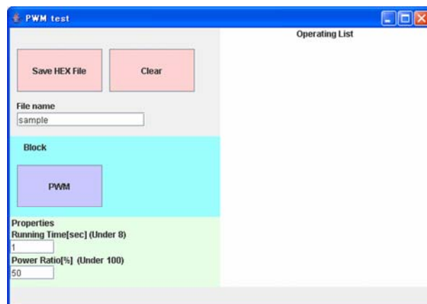
図 6 PIC プログラミング支援のためのワークフローツール
