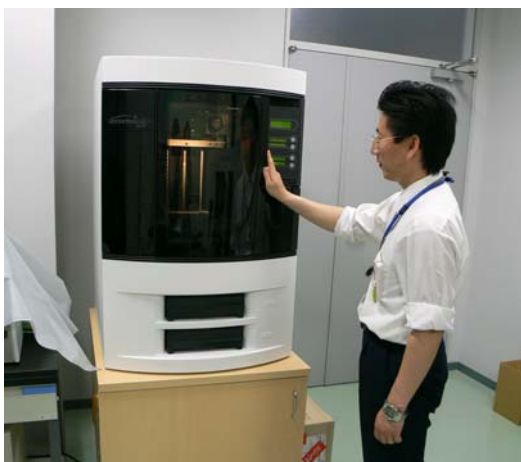
図4 ABS樹脂造形システム
