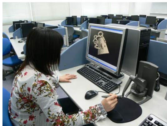
図3 触覚式3次元モデリングシステム
