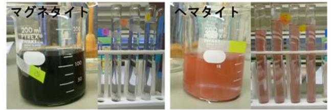
図4. 磁性物質混合水の原液と磁気分離後のサンプル
